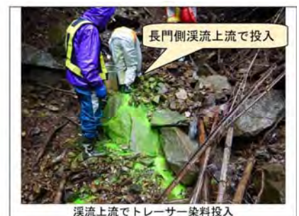
長門側溪流上流で投入 溪流上流でトレーサー染料投入
